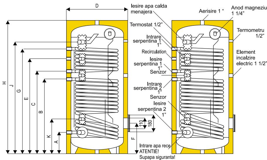
**Schema conectare hidraulica**
