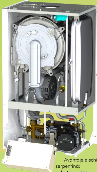
Noul schimbător de căldură ce echipă centrală MKDens, este un schimbător de căldură integrat și compact, cu o singură serpentină din oțel inoxidabil, cu o secțiune ovală. Schimbătorul de căldură este compus dintr-o cameră de ardere, o zonă de condensare și un disc metalic izolat, protejat cu o fibră ceramică de siliciu, care separă cele două zone.
