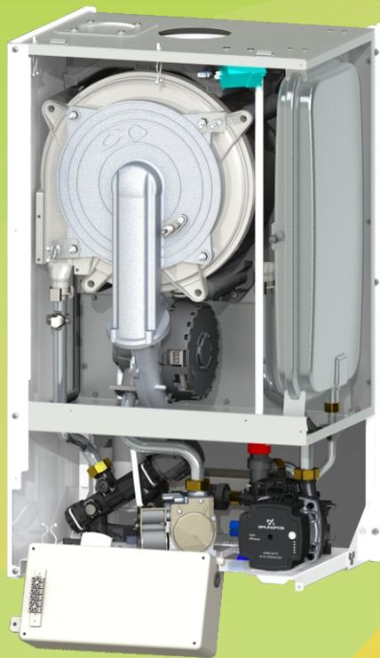
Noul schimbător de căldură ce echează centrală MKDens25, este un schimbător de căldură integrat și compact, bazat pe o singură serpentină din oțel inoxidabil, cu o secțiune ovală. Schimbătorul de căldură este compus dintr-o cameră de ardere, o zonă de condensare și un disc metalic izolat, protejat cu o fibră ceramică de siliciu, care separă cele două zone.
