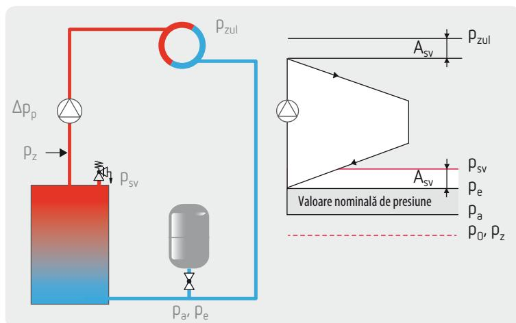
Sistemul de menținere a presiunii este implementat în amonte de pompa de circulație, adică pe partea de aspirație. Conceptul este cel mai utilizat în mod ușual pentru că necesită cel mai redus efort tehnic.
