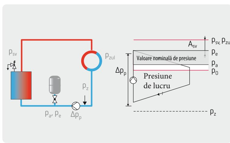
Sistemul de menținere a presiunii este implementat în aval de pompa de circulație, deci pe partea de presiune. Pentru a determina presiunea statică, trebuie luată în calcul o gamă de presiune diferențială specifică a sistemului pompei de circulație (50...100%). Tipul de aplicații este limitat la câteva situații individuale, în special la instalații de încălzire solare.
